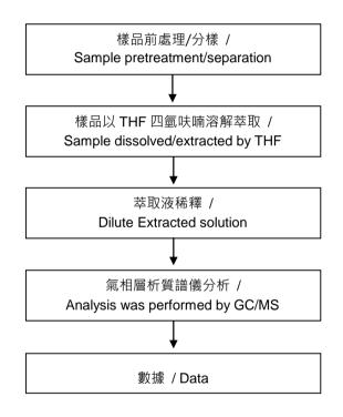
【測試方法/Test method: IEC 62321-8】
